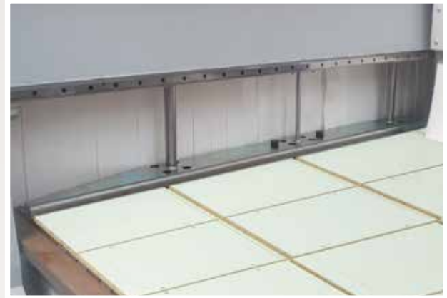
Auxiliary panels unloading unit: allows the machined pieces to be taken off the working table that will then be cleaned by the suction device. (opt.) Dispositivo de ayuda a la descarga. Permite la expulsión de las piezas mecanizadas desde la mesa de trabajo y efectúa la limpieza gracias al propio sistema de aspiración. (opt.) Extra ontladaatsysteem: deze laat toe om de bewerkte delen van de werktafel te nemen, welke daarna middels het afzuigsysteem wordt gereinigd. (opt.)
