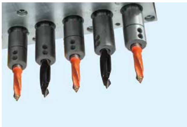
Boring head for vertical boring operations with independent mandrels. (opt.) Unidad para operaciones de taladrado vertical con ejes porta-brocas independientes. (opt.) Boorunit voor verticale boorbewerkingen met onafhankelijke boor-spindels. (opt.)
