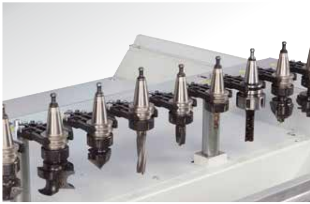
Tool magazine for automatic tool change. ISO 30 cone attachment. Almacén herramientas para cambio automático de herramientas. Ataque cono ISO 30. Gereedschapsmagazijn om automatisch gereedschap te wisselen. ISO 30 opspansysteem.
