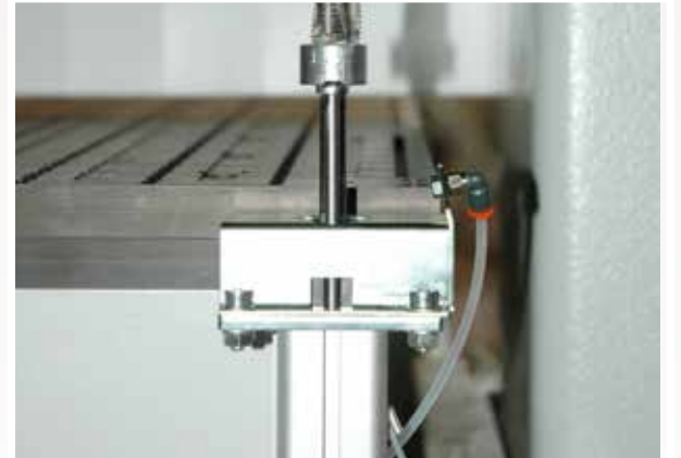
Automatic device for tool length measurement. (opt.) Dispositivo automático de medida de longitud herramienta. (opt.) Automatisch meten van de gereedschapslengte. (opt.)
